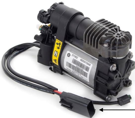
1. Fissare il connettore di alimentazione del motore inserendolo nella parte inferiore e fissandolo con il gancio triangolare sul retro.
